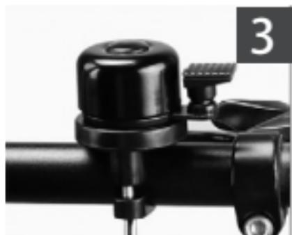
最初にはずしたネジを使い、プラスドライバーで締め付けます。
