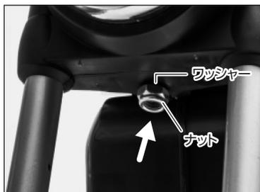
下側にワッシャーとナットを取り付け、付属のレンチでしっかりと締め付けます。※組立動画ではワッシャーの取り付けが省略されております。
