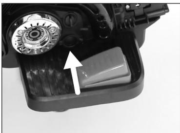
コードを挟まない様にして車体にフットペダルを差し込み取り付けます。
