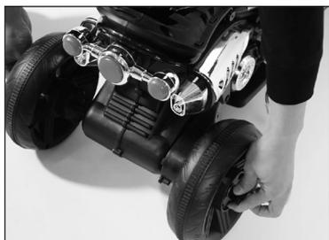
2つのレンチを使い、両側から締め付けて固定します。
