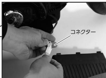
フットペダル側から出ているコネクタと車体側のコネクターを接続します。
