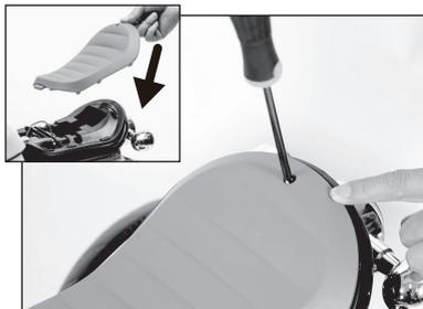
シートをかぶせて、ドライバーでネジをしっかりと締めて固定します。
