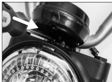
ネジ2本を使用して、ドライバーで締め付けて、しっかりと固定します。
