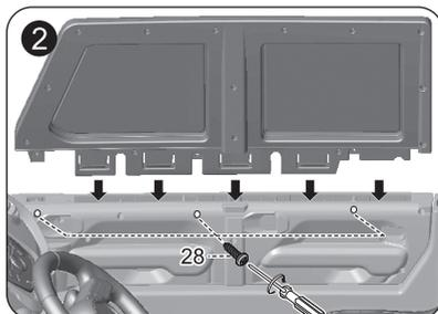
左右のウィンドウ(部品15)を車体両側にある取付け位置に差し込み、軽く押し込んでから、ウィンドウ用ネジ(部品28)で締めつけます(6箇所)。
