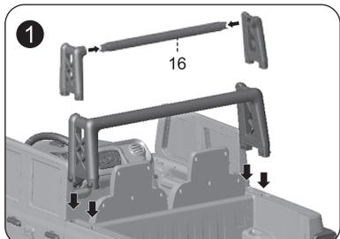
ガードバー(部品16)は、左・中・右の3部品を接続して組み立て、車体両側の図の位置に差し込み、しっかりとはめて固定します。
