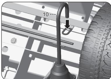
ステアリングロッド(部品10)を車両前方の図の位置に差し込みます。
