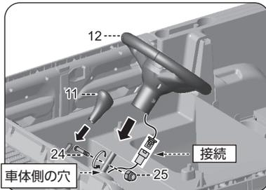
プラグを接続し、車体側の穴に入れ、ハンドル(部品12)をステアリングロッドの先端に取付けます。その後、ハンドル用ネジ(部品24)とハンドル用ナット(部品25)で固定し、最後にシフトレバー(部品11)を差し込みます。
