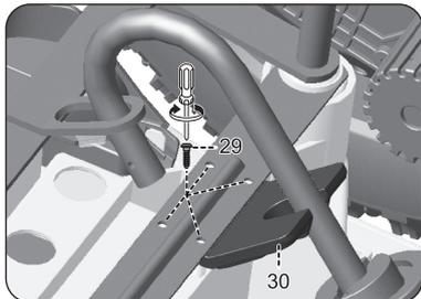
スイングレバー固定ブロック(部品30)を前輪車軸の下に置き、ステアリングロッドを引っ掛けてスイングレバー固定ブロック用ネジ(部品29)を図の穴に締めつけます(4箇所)。
