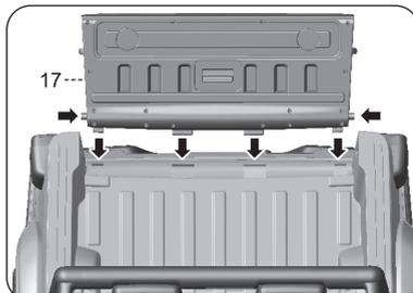
トランクドア(部品17)両端のスピンダルを内側に押し込み、車両後部の図の位置に差し込み、固定します。
