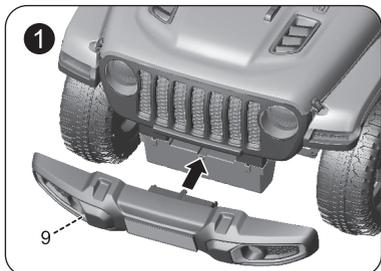
フロントバッフル(部品9)を図の位置に取付け、車体の底面からネジ(部品23)を締めます。
