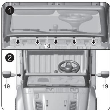
フロントガラス(部品18)と左右のバックミラー(部品19)を図の位置に差し込みます。
