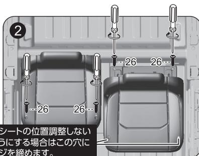
助手席シート(部品14)のジョイントを図①の位置に取付け、シート用ネジ(部品26)で締め付けます(2箇所)。次に、運転席シート(部品14)を図①の位置にはめ込み、シート下のレバーを引き上げて前方に引き出し、図②の位置をシート用ネジ(部品26)で締め付けます(2箇所)。※運転席シートを位置調整出来ないようにする場合は、シート手前のネジ穴を使用して取付けます。シート調整についてはP.8をご確認ください。
