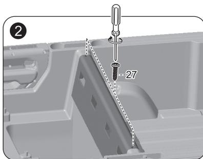
トランクボード(部品13)を図①の位置に取付け、トランクボード用ネジ(部品27)を締めます(2箇所)。
